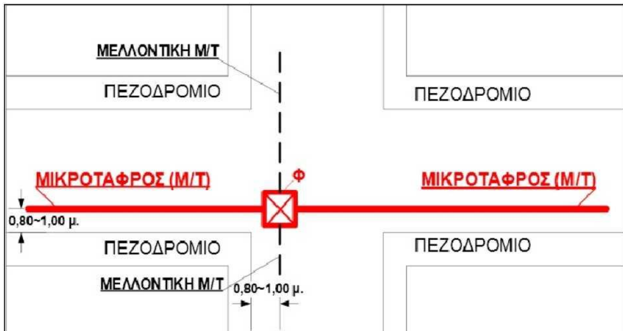
Σχήμα 3: Λεπτομέρειες Κατασκευής Μ/Τ και Φρεατίων
